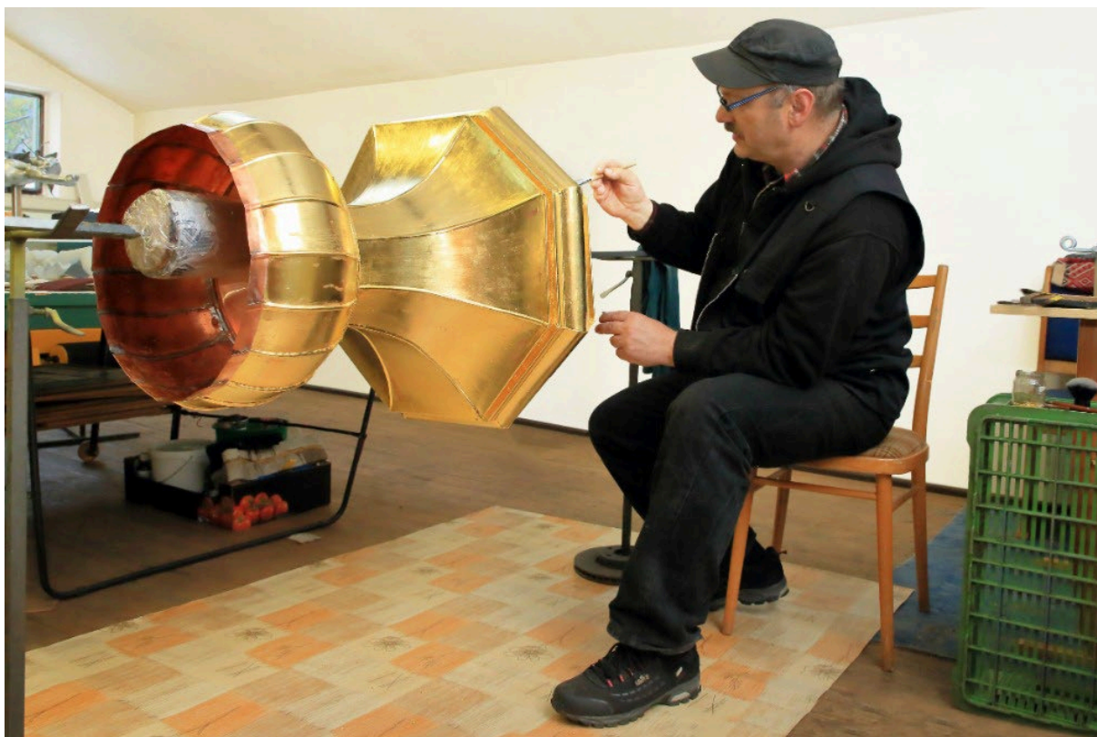
2020 – Útvina – nová bání kostela. Kovářská, klempířská práce a pozlacování
